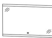
mit LED-Acrylstreifen oben und unten, 1 Sensor für Emotion-Beleuchtung
