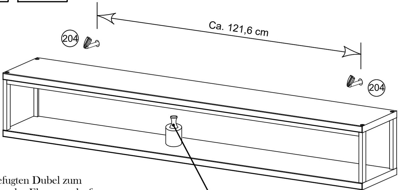
Die beigefügten Dübel zum Aufhängen des Elements dürfen nur bei Betonwänden eingesetzt werden, bei anderen Wandarten müssen entsprechende Dübel zugekauft werden.
