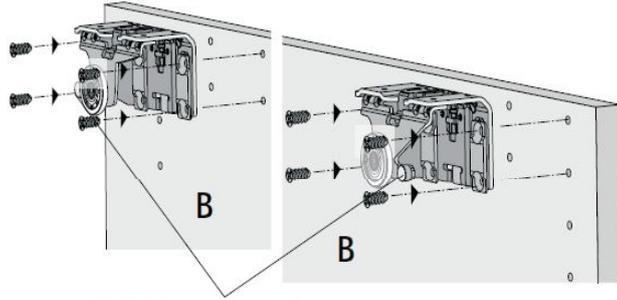
Bei der Positionierung der Laufteile bitte auf links und rechts achten!
