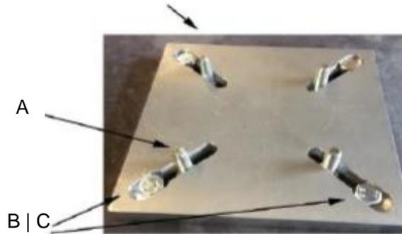
Die Schrauben B oder C (je nach benötigter Länge) in die 4 Ecken setzen und von unten mit dem Schirmständer (Mutter und Unterlegscheiben) befestigen
