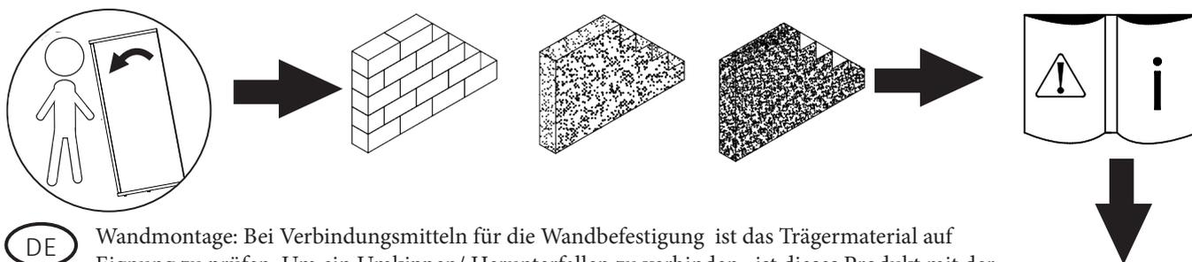
**DE** Wandmontage: Bei Verbindungsmitteln für die Wandbefestigung ist das Trägermaterial auf Eignung zu prüfen. Um ein Umkippen/ Herunterfallen zu verhindern, ist dieses Produkt mit der mitgelieferten Wandbefestigung zu verwenden.
