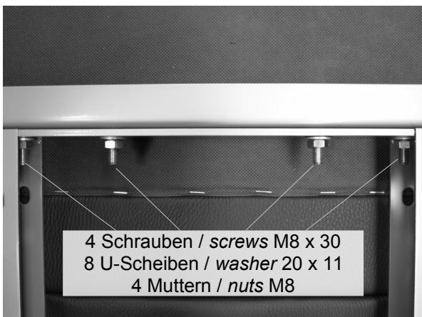
7. Die Metallrahmen mit 4 Schrauben (M8 x 30) und Muttern (M8) fixieren; dabei beidseitig Unterlegscheiben (20 x 11) verwenden.
