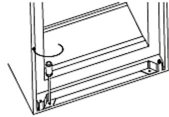
9. Befestigen Sie die obere Halterung mit kurzen Schrauben am Schrank.
