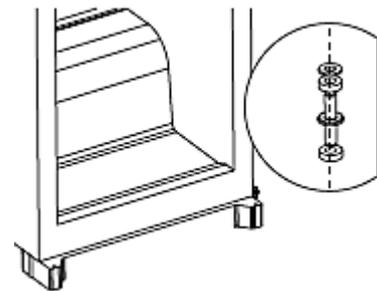
3. Schrauben Sie den oberen Scharnierstift vom Scharnier ab. Drehen Sie das Scharnier um und befestigen Sie den Scharnierstift wieder.
