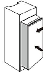
3. Schrauben Sie eine Führung mit den kleinen Schrauben in die Löcher an der Gerätetür. Schieben Sie den Gleiter in die Führung. Öffnen und schließen Sie dann die Gerätetür und die Schranktür vollständig, um zu prüfen, ob sich die Schranktür komplett und reibungslos schließen lässt.
