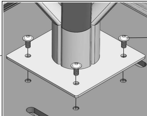
3. Den Unterbau über den Gewindegülsen positionieren und mit dem Oberbau verschrauben.
