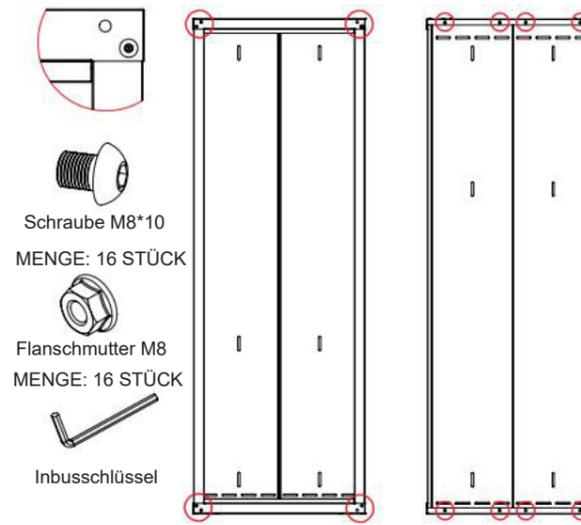
Schrauben Sie die obere und untere Platte an die seitlichen Rückwände.
