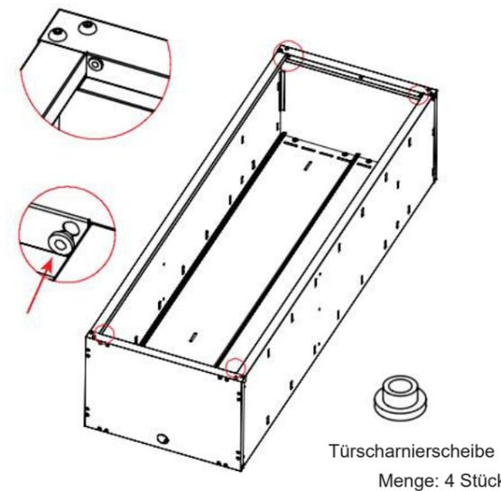
Bringen Sie die Türscharnier-Unterlegscheibe an den vier Ecken der oberen und unteren Platte an.
