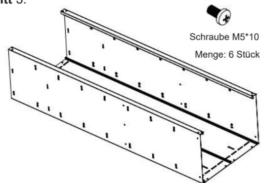
Montieren Sie die rechte Seitenwand gemäß dem zweiten Schritt. Achten Sie auf die Position der oberen und unteren Endlöcher, die beiden Seitenplatten sind symmetrisch.
