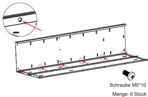
Platzieren Sie die linke Platte wie abgebildet und verbinden Sie sie mit M5\*10-Schrauben mit der Rückplatte. Achten Sie auf die Position der oberen und unteren Endlöcher.
