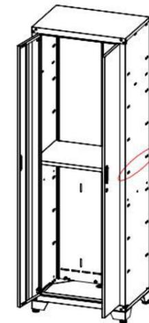
Stellen Sie den Schrank aufrecht, installieren Sie eines der Regale in der Mitte des Schrankes (zum Verriegeln der Tür) und passen Sie die anderen beiden Regale nach Belieben an. Das ist alles erledigt, danke.
