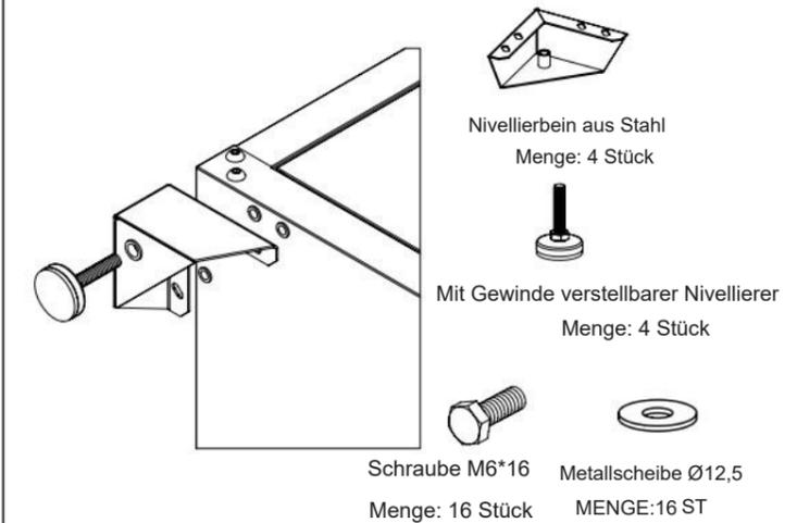
Schrauben Sie den verstellbaren Nivellierfuß mit Gewinde in die Unterseite des Nivellierfußes aus Stahl und befestigen Sie den Nivellierfuß aus Stahl mit 4 M6\*16-Schrauben an der Unterseite der Bodenplatte, sodass die Außenseite mit der Bodenplatte ausgerichtet ist. Installieren Sie die anderen drei Füße auf diese Weise.
