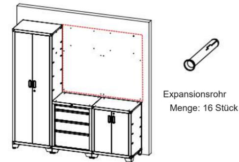
Planen Sie die Platzierung des Werkzeugschranks, bestimmen Sie die Position des Verbindungslochs zwischen der Hängetafel und dem Wandschrank und befestigen Sie das Ausdehnungsrohr, das etwa 4 mm über der Wand liegt. Die Füße des Hochschranks und des Unterschranks können angehoben werden, und die Position des Expansionsrohrs kann etwas höher sein.
