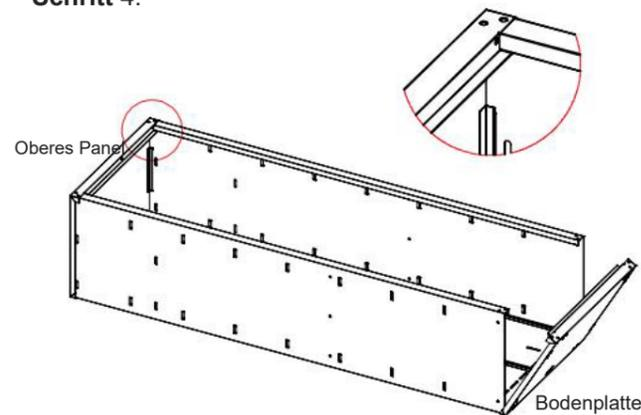
Um die oberen und unteren Paneele zu installieren, sollten die Seitenpaneele zwischen den dreieckigen Blöcken auf der Innenseite der oberen und unteren Paneele und den Seiten eingefügt werden. Ein Ende der vier hüftförmigen Löcher der Seitenplatte ist das obere Ende.
