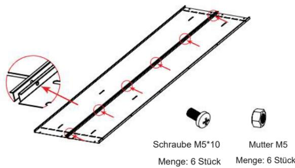
Legen Sie die beiden Rückwände flach hin und verbinden Sie sie mit M5\*10-Schrauben und Muttern. Beachten Sie, dass sich die oberen und unteren Endlöcher an derselben Position befinden.
