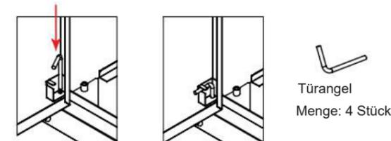
Um die linke Tür zu installieren, richten Sie das Türscharnierloch an der Unterseite der linken Tür mit der Mitte der Türscharnierscheibe auf der linken Seite der Bodenplatte aus, setzen Sie das Türscharnier ein und stecken Sie dann das Türscharnier am Türscharnier fest Waschmaschine. Montieren Sie das Türscharnier und die rechte Tür auf die gleiche Weise.
