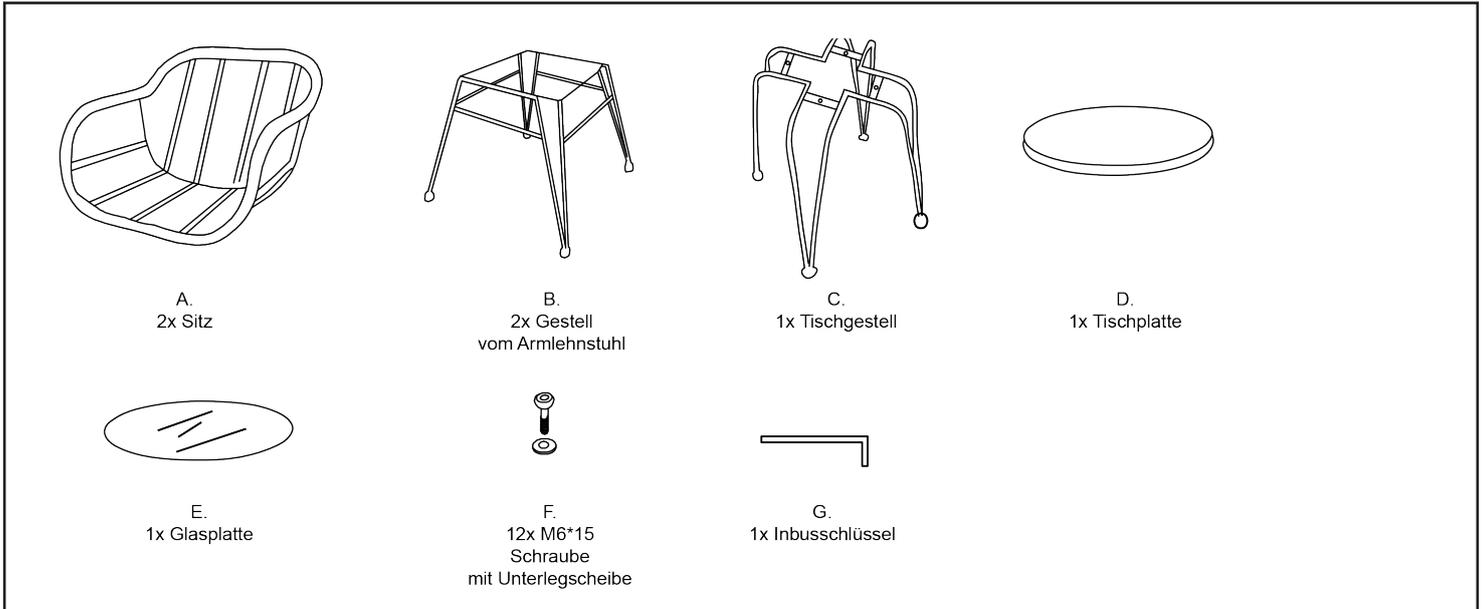
Aufbau der Armlehnstühle: befestigen Sie die Stuhlbeine (B) mittels Schrauben und Unterlegscheiben (F) am Sitz (A).
