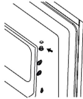
5. Drehen Sie die Gefrierbereichstür um und richten Sie die Scharnierseite nach links aus. Befestigen Sie die Tür mit dem Halter.
