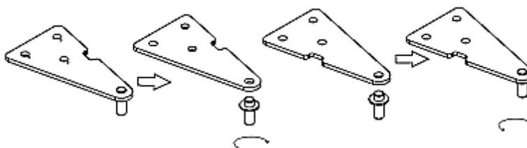
8. Setzen Sie die Tür wieder ein und bringen Sie darauf das obere Scharnier auf der linken Seite an. Achten Sie darauf, dass die Tür ordnungsgemäß ausgerichtet ist und die Dichtungen ordnungsgemäß anliegen, bevor Sie das obere Scharnier endgültig festziehen.
