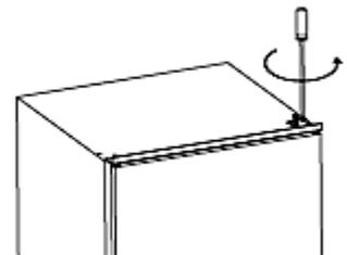
2. Schrauben Sie das untere Scharnier des Gefrierbereichs ab. Nehmen Sie die Tür ab. Lagern Sie die Tür an einer Stelle, an der sie nicht verkratzt werden kann.
