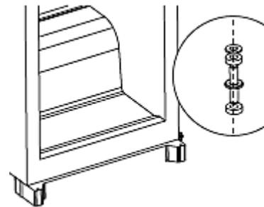
7. Schrauben Sie den oberen Scharnierstift vom Scharnier ab. Drehen Sie das Scharnier um und befestigen Sie den Scharnierstift wieder.
