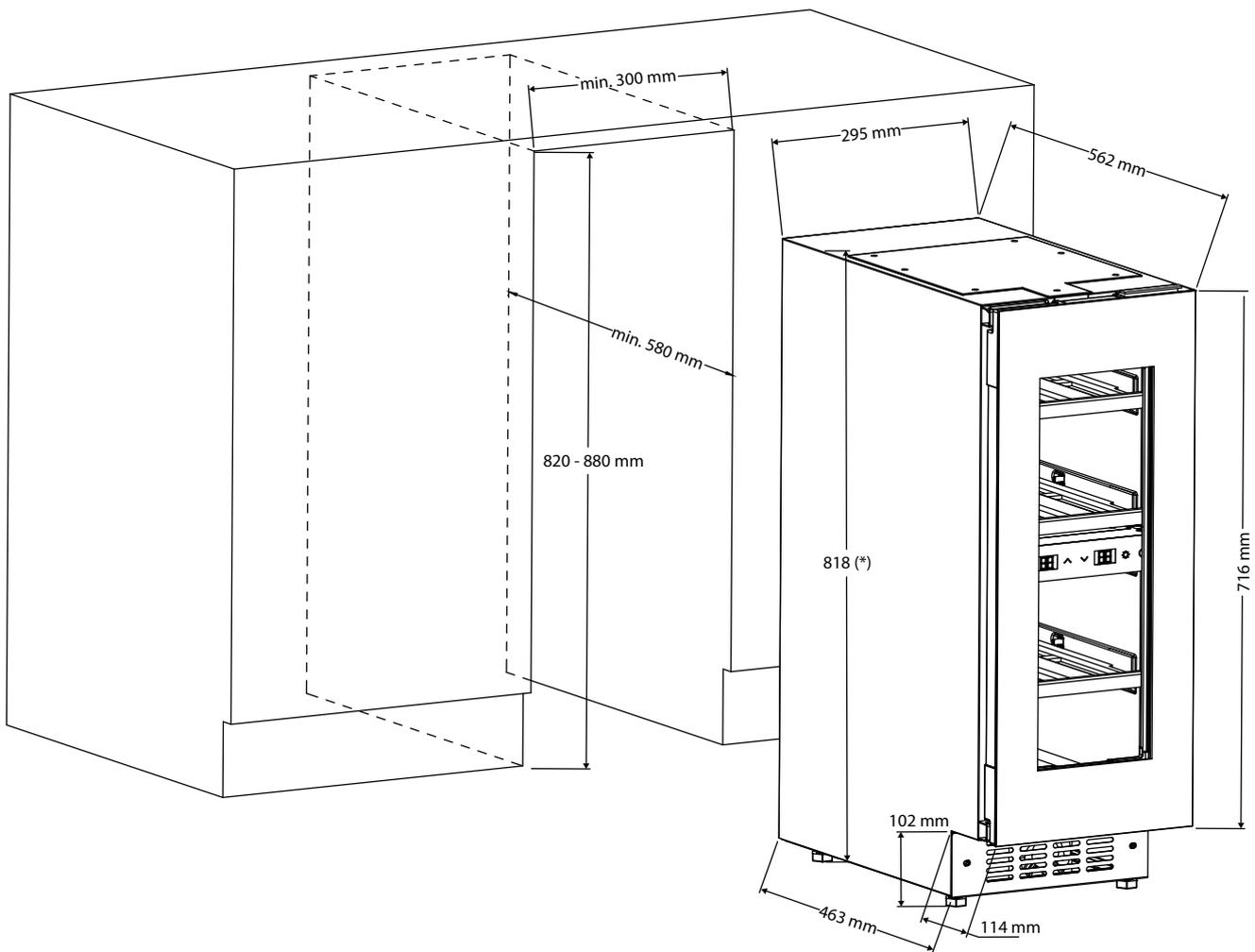
\*Die Einbauhöhe kann durch die verstellbaren Füße bis zu 878 mm erhöht werden.
