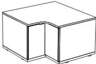
Bei einem **solostehenden** Eckteil wird das Deckblatt passend zum Korpus gefertigt. Der vordere Winkel ist leicht abgerundet.
