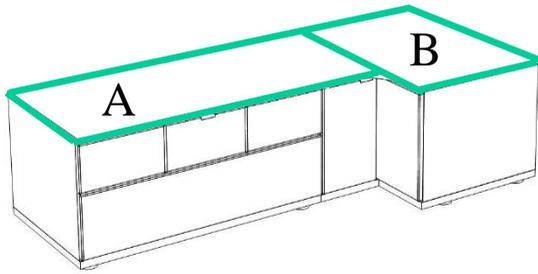
Ist auf der rechten Seite des Eckkorpus **kein** Anschlusskorpus geplant, erfolgt die Planung der Deckblätter: Deckblatt B = komplett über den rechten Schenkel der Ecke
