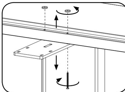
7. Feder montieren und zweite Tischplatte positionieren
