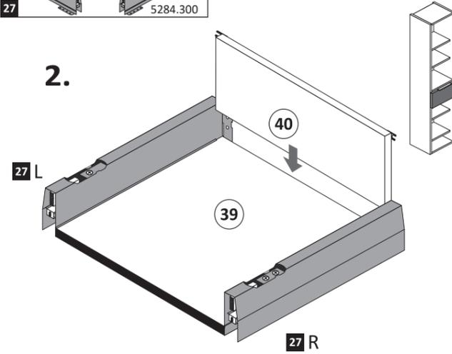
4. Führen Sie die Schubkastenblende mit dem Beschlag wie abgebildet in die Zargen ein. Der Beschlag rastet ein!
