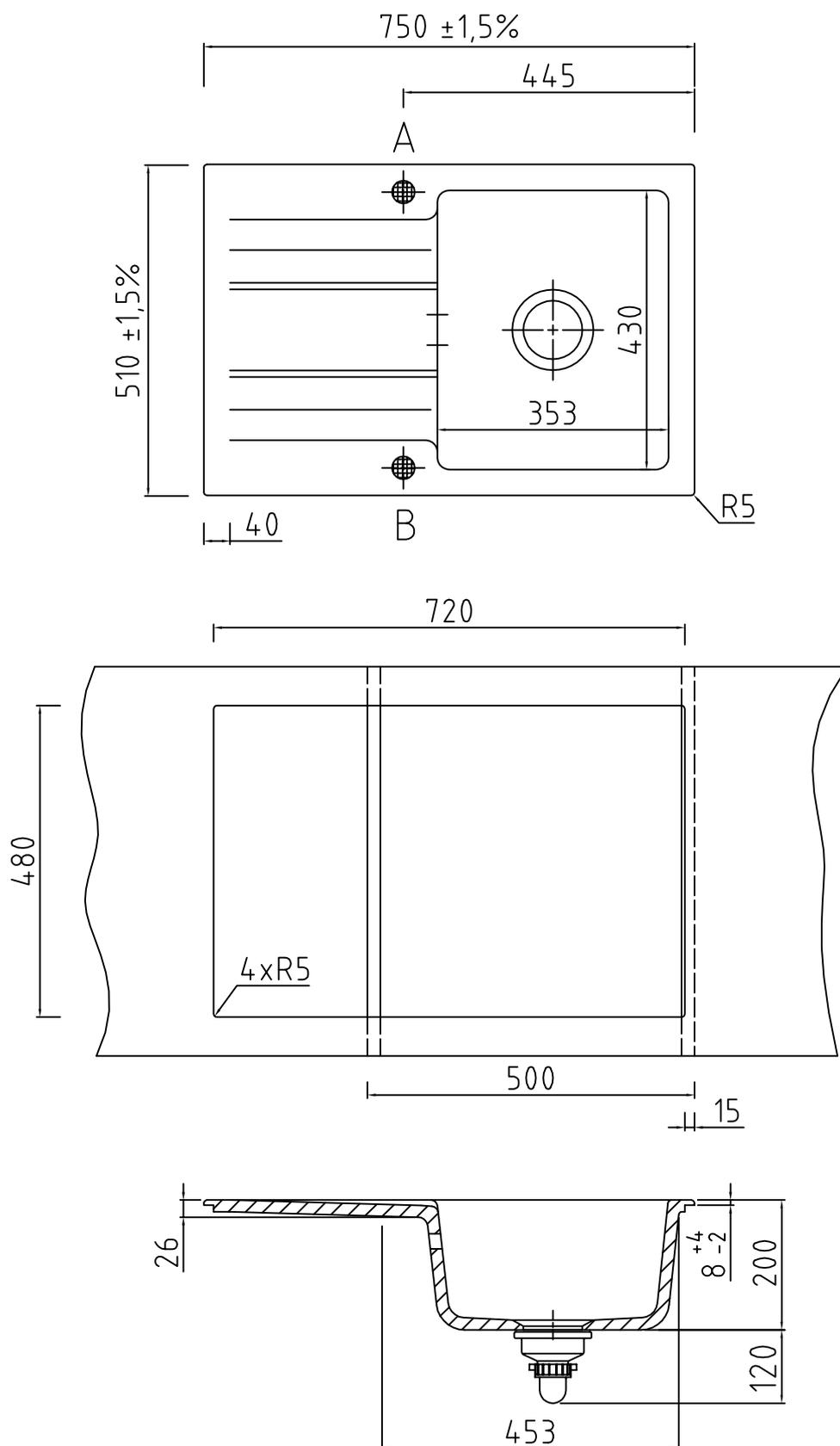
Keine Armaturbohrung vorhanden. Keine Sollbruchstellen. Bohrungen nach individueller Anordnung (● Pos. A und B, siehe Zeichnung).
