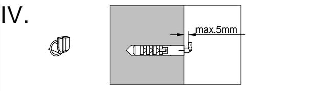
\*Befestigungsdübel ist kein Bestandteil der Verpackung. Es ist nötig, einen geeigneten Dübel zu wählen, je nach der Tragfähigkeit und Zusammensetzung der Mauer, an die Schränke gehängt werden.
