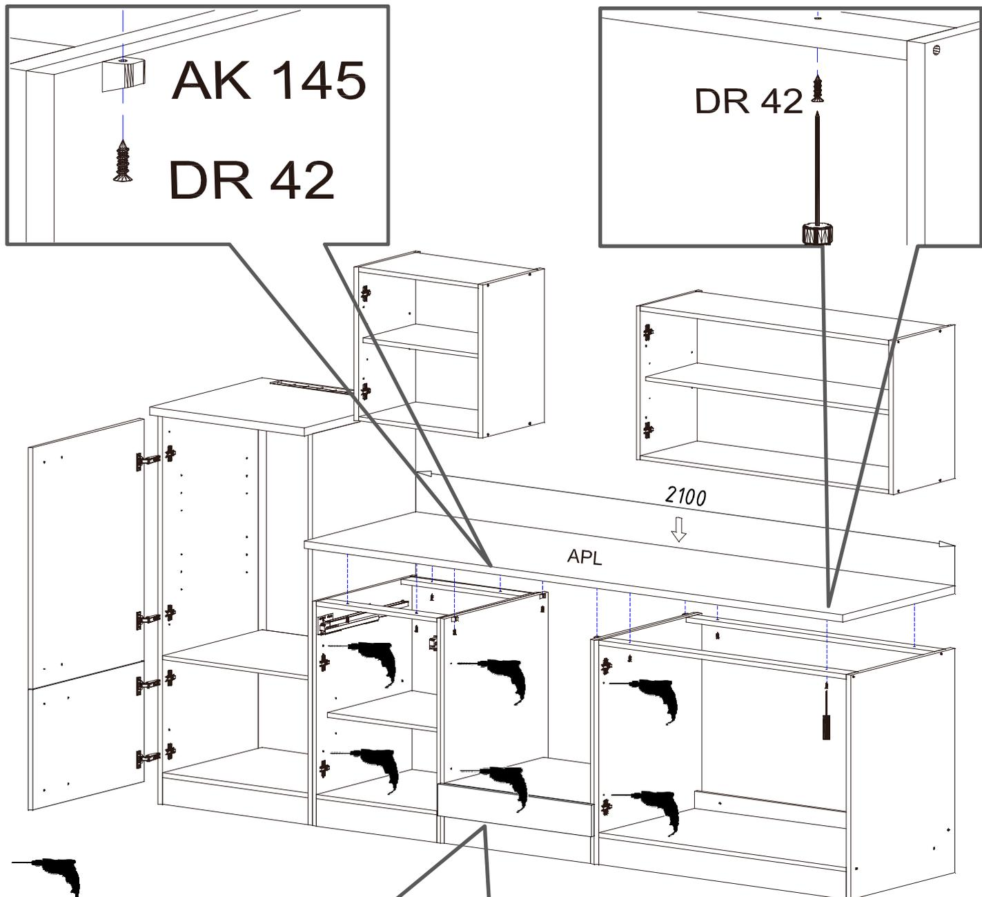
Mit  $\varnothing 5\text{mm}$  Bohrer durchbohren
