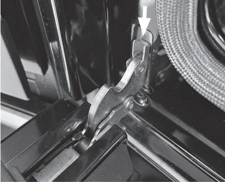
Klappen Sie die Verriegelungen an beiden Scharnieren ganz nach unten, um die Scharniere zu entriegeln. Nehmen Sie dafür ggf. einen Schraubendreher zur Hilfe.
