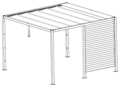
⊕ Die SICHTBLENDE kann auf allen 4 Seiten der SCHATTENMANUFAKTUR montiert werden - links oder rechtsbündig.
