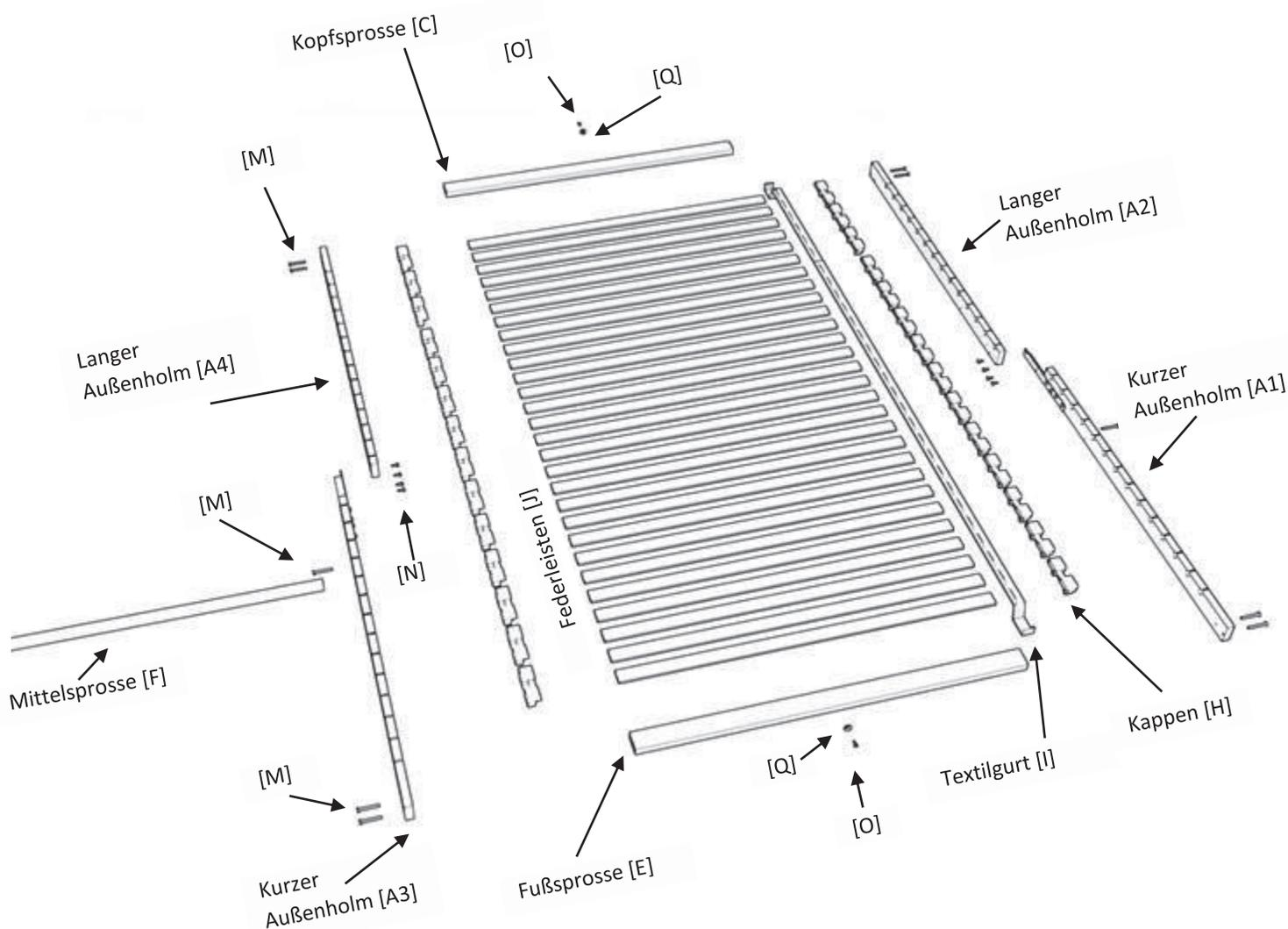
Abbildung ähnlich und technische Änderungen vorbehalten, je nach Ausführung unterschiedliche Anzahl von Federleisten möglich. Nutzen Sie die beiliegende Musterkarte und orientieren Sie sich an den nachfolgenden Montageschritten.
