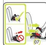
8. Rütteln Sie am Kindersitz, um sicherzustellen, dass er sicher befestigt ist und kontrollieren Sie erneut die Sicherungsknöpfe 07, um sicherzustellen, dass **beide** vollständig grün sind.
