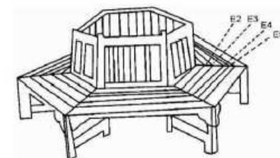
Abschließend verbinden Sie die Bretter E2, E3, E4 und E5 mit dem Gerüst. Die Bank ist nun fertig für den Gebrauch.
