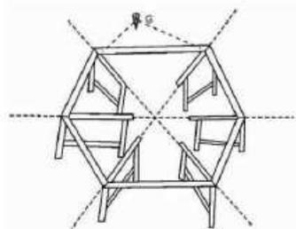
Verbinden Sie alle Beine miteinander, so dass ein gleichmäßiges Sechseck entsteht. Dazu müssen Sie die Beine beim Verschrauben richtig zueinander ausrichten. Achten Sie darauf die Schrauben nicht zu überdrehen.
