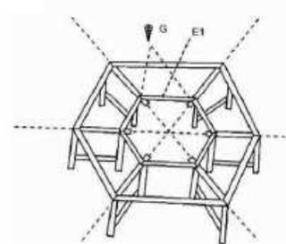
Verschrauben Sie nun die kurzen Bretter E1 mit den Beinen B. Verwenden Sie hierzu wieder die Schrauben G. Rücken Sie das Gerüst nun zurecht.
