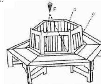
Verbinden Sie die Rückenteile D miteinander, so dass eine komplette Rückenfläche entsteht. Nutzen Sie dazu die Schrauben C. Im Anschluss setzen Sie die Rückenlehne auf das errichtete Gestell und befestigen es mit Schraube F.
