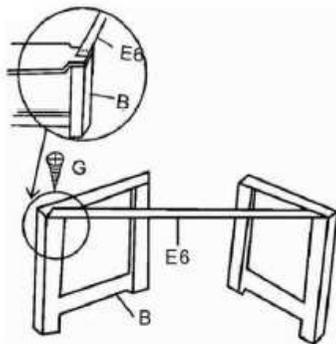
Verbinden Sie die Bretter E6 mit den Beinen B unter Zuhilfenahme der Schrauben G. Die Löcher sind dazu bereits vorgebohrt.
