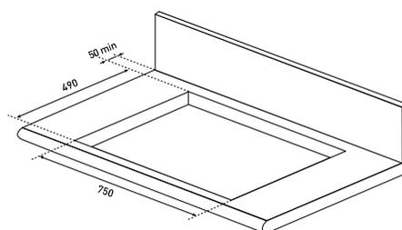
Für den flächenbündigen Einbau umlaufend min. 1,8 mm für die Silikonfuge berücksichtigen.
