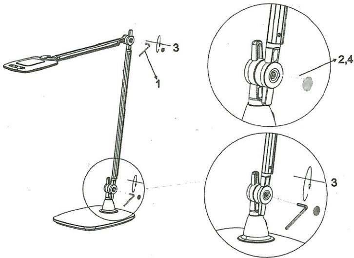
**(DE) Montageanleitung zur Befestigung der Lampe bei schwenkendem Arm.**
