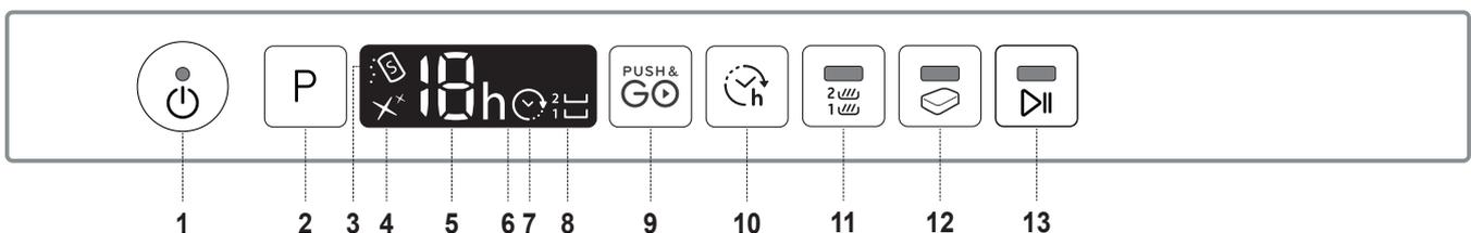
1. Ein-Aus/Reset Taste mit Anzeigelicht
