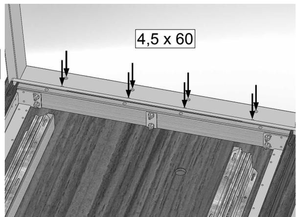
4. Die Spax-Schrauben vorsichtig in den Metallbügel schrauben, so dass sich dieser nicht verbiegt. Den zweiten Unterbaubügel ebenso (P. 2 - 4) montieren.
