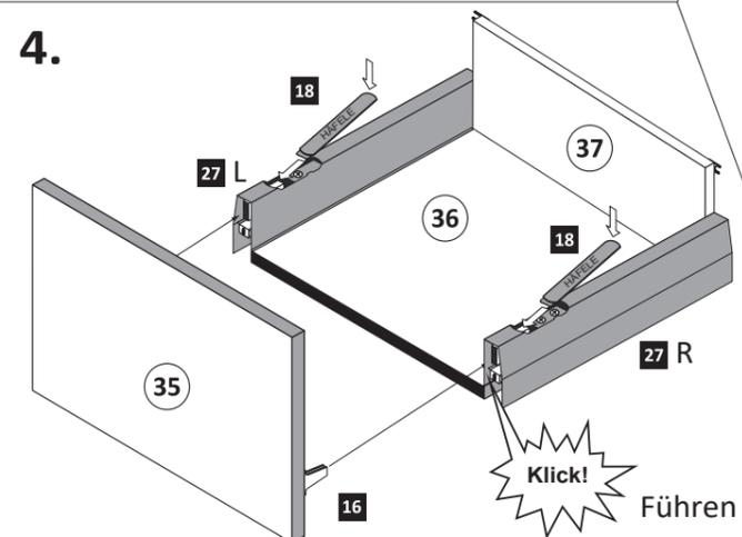
Führen Sie die Schubkastenblende (35) mit dem Beschlag (16) wie abgebildet in die Zargen (27) ein. Der Beschlag (16) rastet ein!
