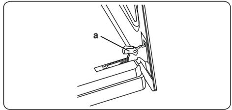
3. Sluit de deur tot deze bijna volledig en verwijder de deur door deze naar u toe te trekken.
