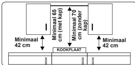
Het apparaat mag niet worden geïnstalleerd direct boven een vaatwasmachine, koelkast, diepvriezer, wasmachine of wasdroger.
