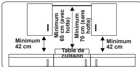
Cet appareil ne doit pas être installé directement au-dessus d'un lave-vaisselle, d'un réfrigérateur, d'un congélateur, d'un lave-linge ou d'un sèche-linge.
