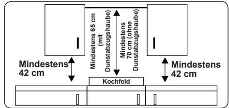
Das Gerät sollte nicht direkt über einem Geschirrspüler, einem Kühlschrank, einem Gefrierschrank, einer Waschmaschine oder einem Wäschetrockner installiert werden.
