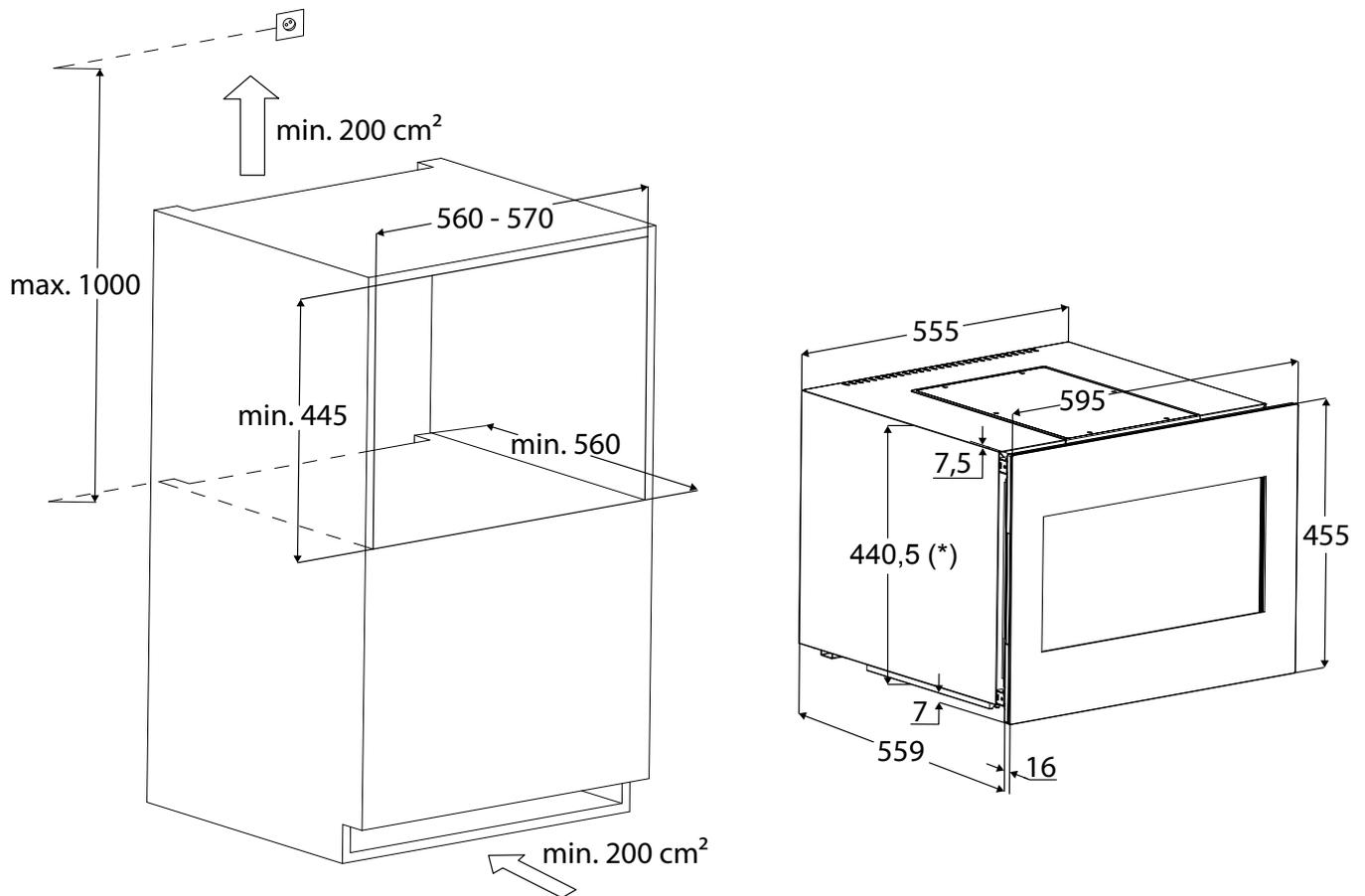
\*Die Einbauhöhe kann durch die verstellbaren Füße bis zu 455,5 mm erhöht werden.
