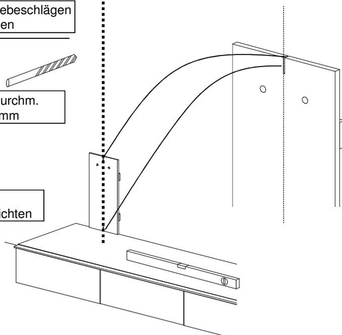
Bohrshablone oben und unten an Mittelachse anlegen,
