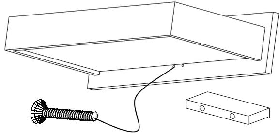
Griffe mit 2 St. "Senkschraube" M4x25 anschrauben.
