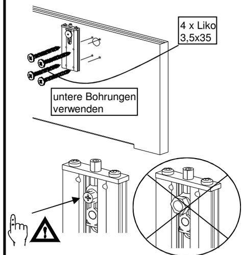
**Abschlußleiste bei oben endendem Paneel montieren**
