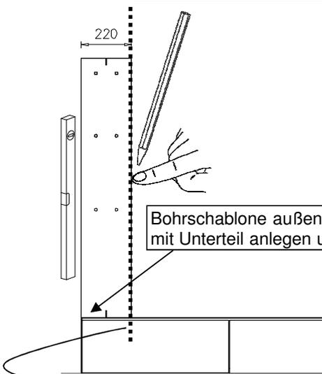
Bohrschablone außen bündig mit Unterteil anlegen und ausrichten
