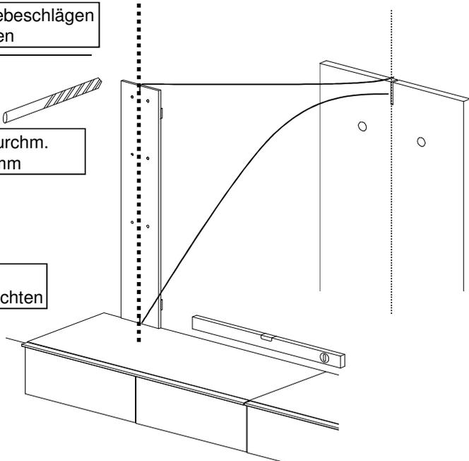
Bohrshablone oben und unten an Mittelachse anlegen, Mitte Nut an der Schablone = Mittelachse
