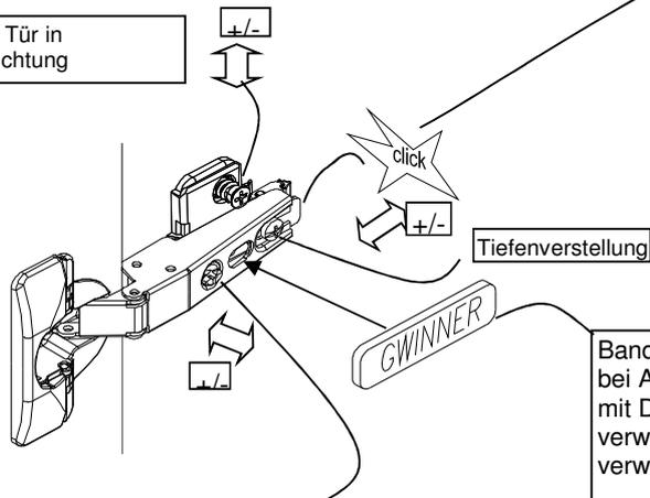
ausrichten der Tür mit der Verstellerschraube in waagerechter Richtung
