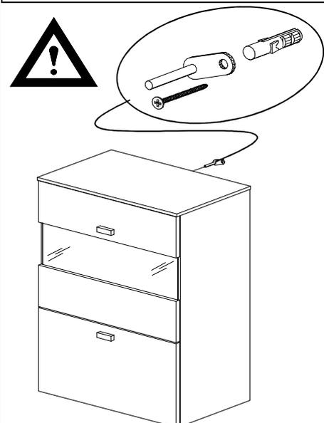
**Bild 3 Schränke ausrichten und AP montieren**
