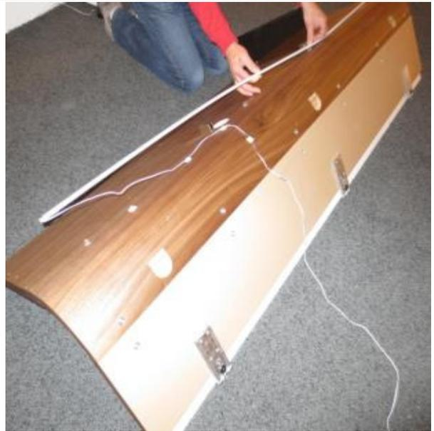
**Bild 7+8:** Hängebeschläge, Gehäuse und Mittelwandbolzen mit Gewindestift SW5 verspannen sowie die Beleuchtung auf das untere Panel **Typ „ B ”** montieren
