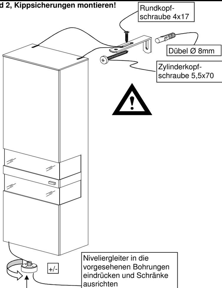
Bei allen U-Schränken 5R und 8R, wird ein Befestigungswinkel mit Metallzapfen als Kippsicherung montiert. Hierbei wird eine Senkschraube 5x60mm und ein Kunststoffdübel Durchm. 8mm verwendet. Nur bei Schrägmontage deckt die **12mm Abdeckplatte** den Beschlag ab.
