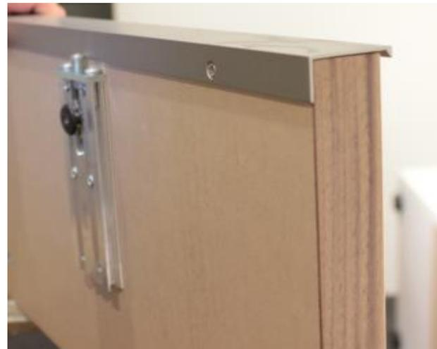
**Bild 15:** Beschlagmontage bei der Variante **Typ " C "** (ohne Rundung) erhält eine Abschußleiste
