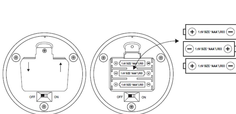
Lampan är endast avsedd att användas i hemmet och endast inomhus. Lampan är ingen leksak. En vuxen ska alltid hålla uppsikt över barn. Ej lämplig för barn under 15 år. Till lampan hör en USB-kabel och ett nätaggregat som ger likström på 5 V och 1 A. Alternativt kan lampan drivas med tre AAA-batterier (ingår inte). Lampans konstruktion får inte ändras på något sätt.
