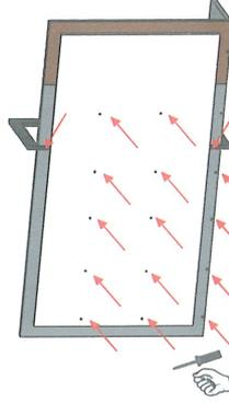
Regalböden von der Rückseite mit den Schrauben 4,5x55mm durch die dafür vorgebohrten Löcher mit dem Panel verschrauben.
