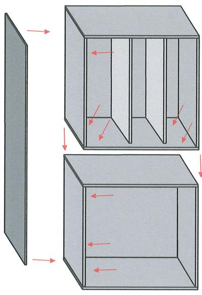
Die Fronten aus den Möbeln ausbauen, Korpen dann vorne und oben bündig ausrichten und verschrauben (4,0x30mm). Das Abdeckblatt mit je einem 8x25mm Holzdübel links und rechts am Korpus ausrichten und dann von Innen mit den Korpen verschrauben (4,0x30mm). Dann das Möbel auf den Rücken legen und die Füße, ggf. mit zusätzlichen Unterboden verschrauben.
