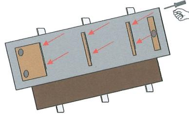
Schrauben 3,5x17mm durch das Loch in den Glasböden mit dem Holzteil darüber verschrauben. Schrauben nicht zu fest anziehen - Bruchgefahr !!
