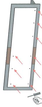
Regalböden von der Rückseite mit den Schrauben 4,5x55mm durch die dafür vorgebohrten Löcher mit dem Panel verschrauben.
