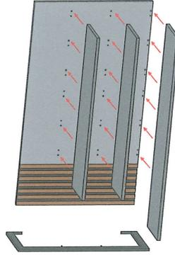
Regalböden und Panel mit den Holzübeln 8x30mm in den 8mm Bohrungen verbinden. Der lange Boden gehört nach unten.
