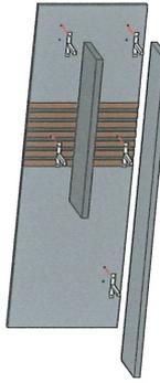
Regalbodenträger von vorne mit Schrauben 4x17mm verschrauben, dafür sind im Panel kleine Bohrungen vorgebohrt.
