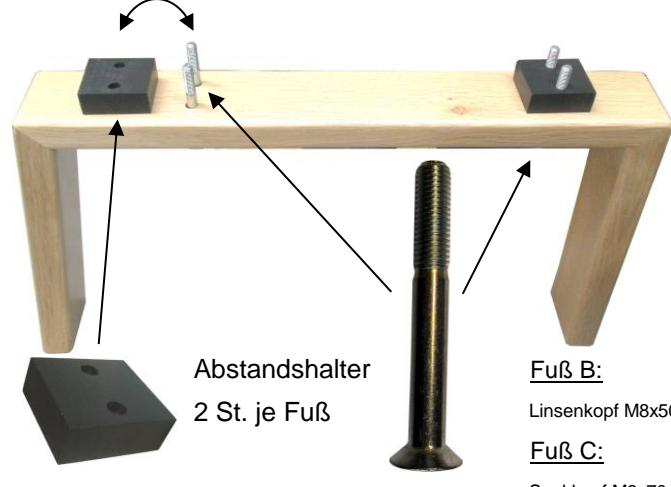
Den Fuß drehen, dabei Schrauben und Abstandshalter festhalten und die Schrauben in die vorgesehenen Löcher der Grundplatte einstecken.
