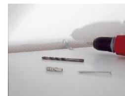
Před zahájením vrtacích prací se ujistěte, že v místě vrtání nevede žádné potrubí ani kabely (plyn, voda, elektřina, topení, odtoky).
