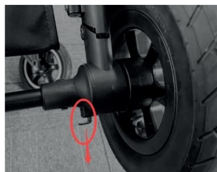
Ziehen Sie den Metallknopf zum Entriegeln der Vorrichtung
