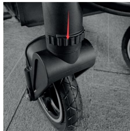
Dra monteringsdelen åt vänster för att låsa och låsa upp framhjulen.
