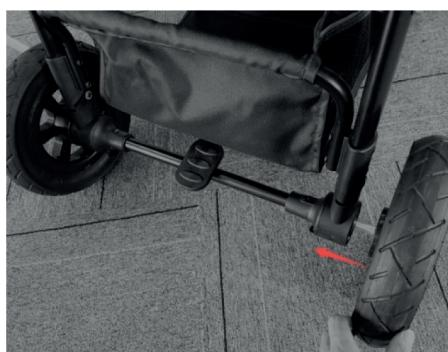
Poussez la pièce de roue arrière dans le trou jusqu'à ce qu'elle soit verrouillée.
