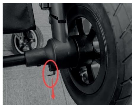
За отключване на устройството дръпнете металното копче
