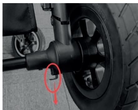
Na odblokovanie mechanizmu ťahajte kovo-vým kolieskom
