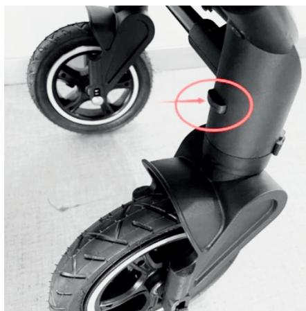
Drücken Sie den Knopf der Schnellwechselvorrichtung nach unten
