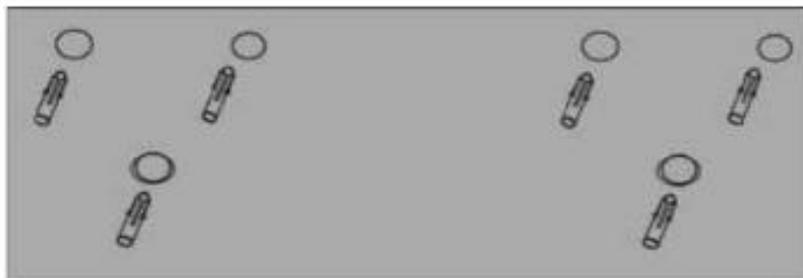
III. Bringen Sie die Halterung mit sechs ST4\*35mm-Schrauben an und vergewissern Sie sich, dass die einzelnen Montagepunkte gut befestigt sind.
