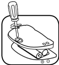
Setzen Sie 2 x 1,5V Micro-Batterien (AAA/LR03) ein, wie auf dem Bild im Inneren des Batteriefaches dargestellt. Achten Sie dabei auf die richtige Polung.
