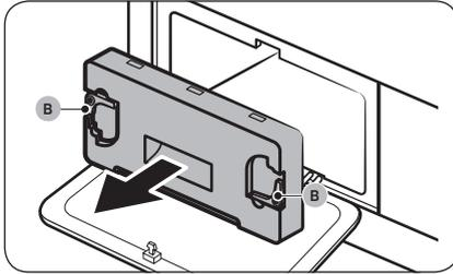
2. Entriegeln Sie die **Fixierungen (B)** der inneren Abdeckung und ziehen Sie dann zum Entfernen an der inneren Abdeckung.
