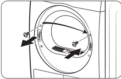
5. Entfernen Sie die obere Schraube auf der linken Seite des Türrahmens und führen Sie sie in die entsprechende rechte Bohrung am Türrahmen ein. Entfernen Sie nicht die Schrauben der unteren Halterung.
