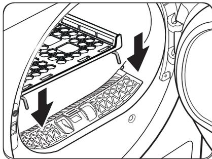
1. Setzen Sie das Trocknerfach so in die Trommel ein, dass die Frontlippen des Trocknerfachs in die Öffnungen der Türmembran eingreifen.
