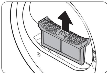
1. Öffnen Sie die Tür des Trockners, fassen Sie den Flusenfilter oben an und ziehen Sie ihn heraus.
