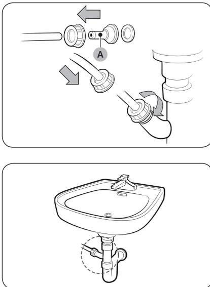
1. Montieren Sie den **Schlauchanschluss (A)** und befestigen Sie ihn am Ende des Zubehörschlauchs (siehe Abbildung).
