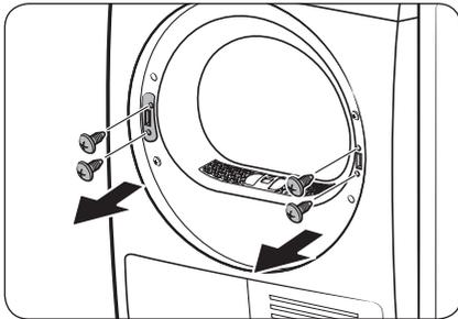
6. Entfernen Sie zuerst die 2 Klammerschrauben am rechten Rahmen und dann die 2 Halterungsschrauben am linken Rahmen.
