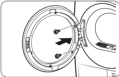
10. Führen Sie das Türscharnier in die entgegengesetzte Position am Türrahmen ein und ziehen Sie dann die 2 Bolzenschrauben fest.
