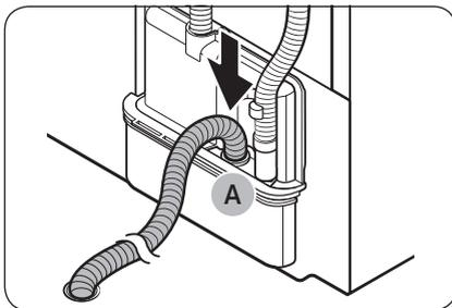
2. Verbinden Sie das eine Ende des Zubehörschlauchs (langer Abwasserschlauch) mit **Anschluss (A)**.
