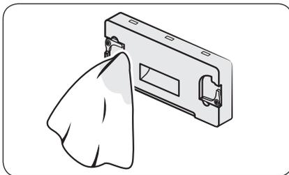
4. Reinigen Sie die innere Abdeckung mit einem weichen, feuchten Tuch.
