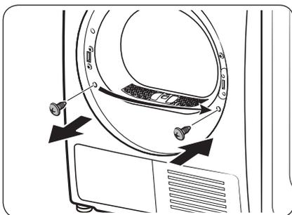
8. Entfernen Sie die untere Schraube am linken Rahmens und führen Sie sie in die entsprechende Bohrung am rechten Rahmen ein.
