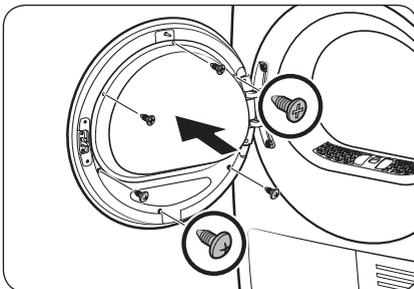
12. Ziehen Sie die 3 Halterungsschrauben an der Oberseite fest. Ziehen Sie dann die 3 Halterungsschrauben an der Unterseite fest.
