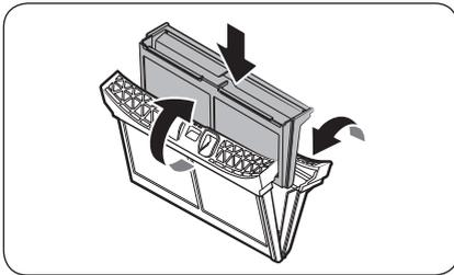
5. Setzen Sie den inneren Filter in den äußeren Filter ein und setzen Sie den Flusenfilter wieder in der ursprünglichen Position ein.
