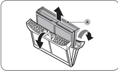
2. Öffnen Sie den äußeren Filter und entnehmen Sie den **inneren Filter (A)**.
