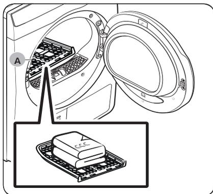
2. Verteilen Sie die Wäschestücke so im Trocknerfach, dass die Luft ausreichend zirkulieren kann. Falten Sie Kleidungsstücke zusammen und legen Sie sie flach in das Trocknerfach.
