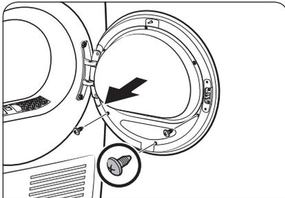
2. Entfernen Sie die Schrauben an der inneren Glashalterung der Gerätetür.
