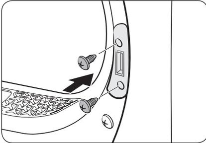
9. Setzen Sie den Hebelhalter auf den rechten Rahmen und ziehen Sie dann die 2 Halterungsschrauben fest.
