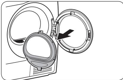
4. Entfernen Sie die Scharnierschrauben und nehmen Sie die Tür ab.
