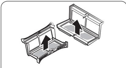
3. Klappen Sie den äußeren Filter und den inneren Filter auseinander.
