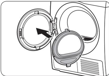
11. Setzen Sie den inneren Glashalter in die Türabdeckung ein, die Sie gerade am linken Rahmen angebracht haben.
