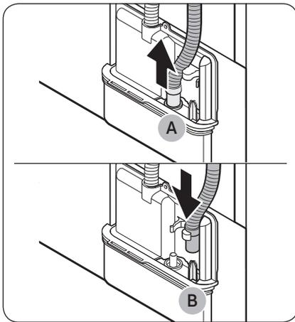
1. Ziehen Sie den Abwasserschlauch von **Anschluss (A)** ab und verbinden Sie ihn stattdessen mit **Teil (B)**.
