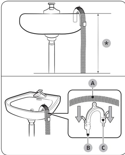
1. Stellen Sie sicher, dass der Auslass des Zubehörschlauchs sich in weniger als **90 cm (\*)** über dem Boden des Trockners befindet.
