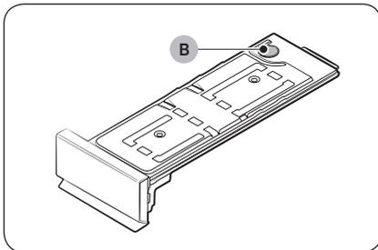
2. Entleeren Sie das Wasser über den **Abfluss (B)** und reinigen Sie den Behälter dann innen.
