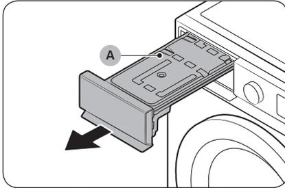
1. Entfernen Sie den **Wasserbehälter (A)** aus dem Trockner.
