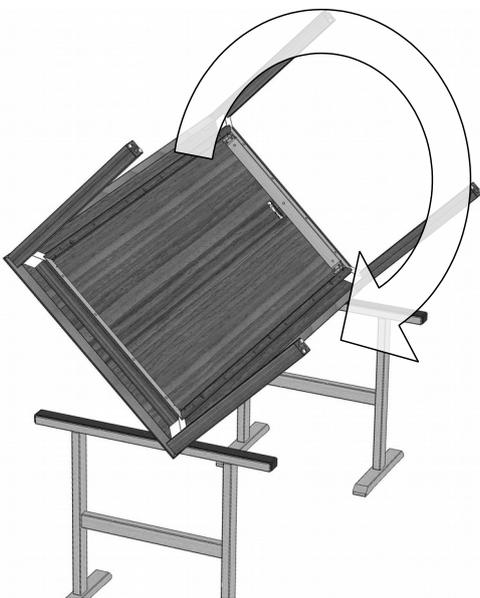
5. Den Tisch wenden, ohne die FüÙe zu belasten und dann gleichzeitig alle 4 Tischbeine auf dem Boden absetzen.
