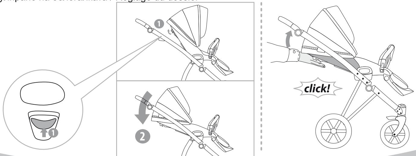
Verstellen der Fußstütze / Justera fotstödet / Podešavanje naslona za noge / Podešavanje oslonca za noge / Nastavení opěrky na nohy / Réglage du repose-pied
