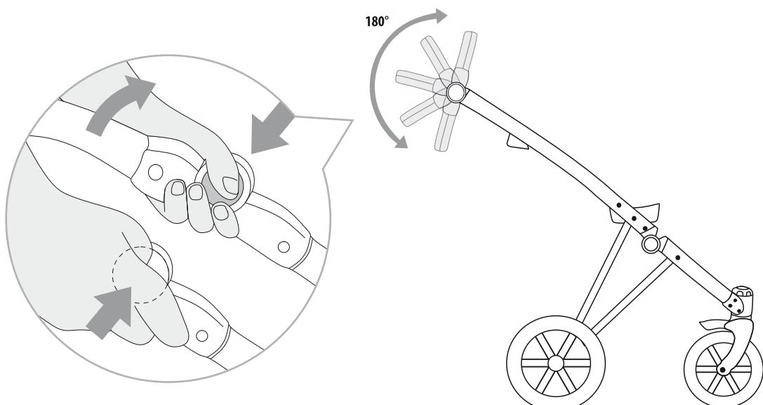
Schwenkbare Vorderräder/ Az első kerekek forgatása/ Točenie predných kolies/ Rotirea roților frontale/ Завъртане на предните колела / Roues avant pivotantes
