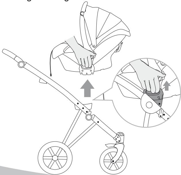
Demontage von Adaptern/ Az adapter leszerelése/ Demontáž adaptéra/ Demontarea adaptorului/ Демонтаж на адаптерите / Démontage des adaptateurs
