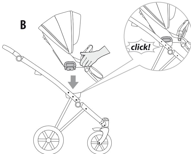
Demontage des Sitzes/ A sportrész leszerelése/ Demontáž podložky do športového kočíka/ Demontarea elementului sportiv/ Демонтаж на столчето за кола / Démontage du siège
