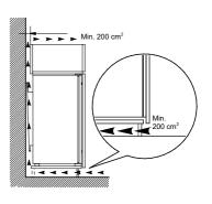
Drücken Sie das Gerät langsam und vorsichtig in das Einbaugehäuse. Vergewissern Sie sich, dass sich die Öffnungsseite so nah wie möglich an der Einbaugehäusewand befindet.
