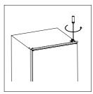
Schrauben Sie das mittlere Scharnier ab und heben Sie dann die untere Tür an. Legen Sie die Tür auf eine gepolsterte Oberfläche, um Kratzer zu vermeiden.
