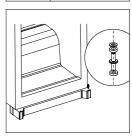
Entfernen Sie den mittleren Montagewinkel auf der linken Seite und montieren Sie ihn auf der rechten Seite. Bringen Sie anschließend die untere Tür wieder an.
