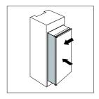
Schrauben Sie mit Hilfe der kurzen Schrauben die Führung an den Montagelöchern auf der Seite der Gerätetür an. Setzen Sie die Gleiter in der Führung ein. Öffnen und schließen Sie die Gerätetür und die Holztür vollständig, um zu überprüfen, ob die Holztür leichtgängig und vollständig geschlossen werden kann.
