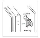
Überprüfen Sie erneut, ob die Tür vollständig schließt, das Gerät ordnungsgemäß abgedichtet wird und sich die Tür leichtgängig bewegen lässt. Wenn dies nicht der Fall sein sollte, dann korrigieren Sie die Gleiter/Führung-Einheit(en). Befestigen Sie anschließend die unteren Montagewinkel mit Hilfe der 2 langen Schrauben am Holzeinbaugehäuse.
