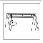
Bringen Sie die Gummiabdichtung auf der Türöffnungsseite am Zwischenraum zwischen Gerät und Holzeinbaugehäuse an.
