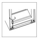
Befestigen Sie die oberen Montagewinkel mit Hilfe von kurzen Schrauben am Holzeinbaugehäuse.
