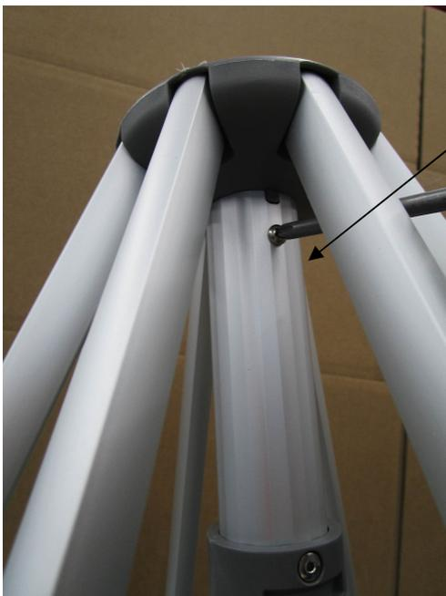
2 Schrauben herausdrehen, Nocken mit dem Cutter abschneiden. Schirmteil in geöffnetem Zustand drehen, bis die Stoffkante waagrecht ist. Neu verschrauben.
