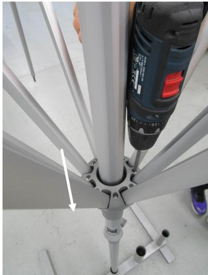
Schrauben am Schieber lösen, Strebe herausziehen.
