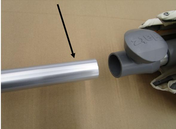
Schraubknopf etwas lösen, defekten Unterstock herausziehen.
