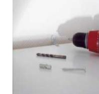
Vor Bohrarbeiten muss geprüft werden, dass an der Stelle des Bohrens keine Leitungen für Gas, Wasser, Strom, Heizung oder Abflüsse verlegt wurden
