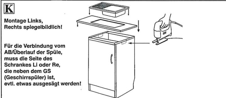
**HINWEIS!** Bei der Montage des Einlassbeckens Dichtungsband von unten ringsum einkleben. Die Befestigungsklammern nur mit einem Handschraubendreher festziehen!
