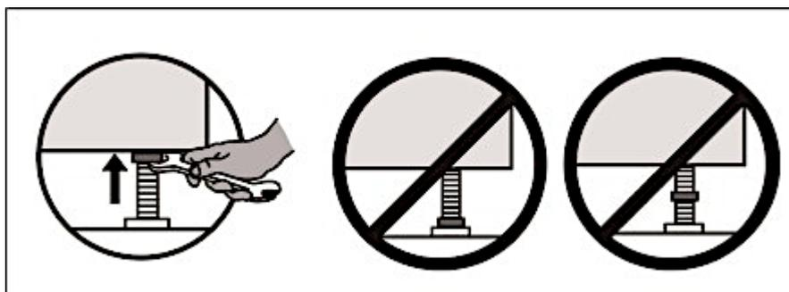
**HINWEIS!** Drehen Sie die verstellbaren Standfüße nicht weiter als **unbedingt** nötig heraus! Je weiter die verstellbaren Standfüße herausgedreht sind, desto stärker kann das Gerät vibrieren.
