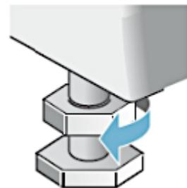
b. Festziehen der Kontermutter: gegen den Uhrzeigersinn (s. Abb. rechts). Verwenden Sie dafür den mitgelieferten Schraubenschlüssel.
