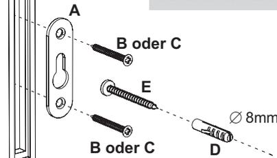
Die Schenkel der Winkel können alternativ nach oben oder unten am Schrank angebracht werden
