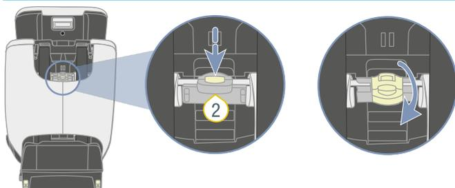
1. Fahren Sie die Kopfstütze maximal ein.
