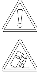
T6 Die Schrankaufhänger dienen zur Kippsicherung des Schrankes und müssen grundsätzlich montiert werden.
