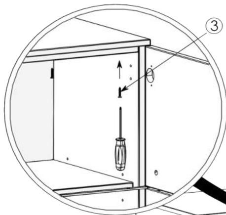
Bohrungen für die Schrauben, um das Abdeckblatt anzuschrauben, liegen soweit hinter dem Traver, so dass eine Montage einfach möglich ist.
